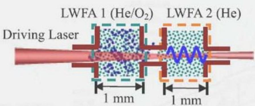
Сразу две группы экспериментаторов сконструировали новый двухступенчатый лазерно-плазменный ускоритель. Электронный сгусток создается и ускоряется до энергии около 1 ГэВ одним-единственным лазерным импульсом, причем длина тандема «инжектор плюс ускоритель» не превышает одного сантиметра. Масштабы современных ускорителей элементарных частиц впечатляют.
